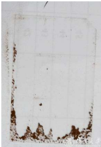
实验室中涂覆除尘涂层的玻璃盖片的重力除尘效果(上图-除尘前,下图-除尘后)
